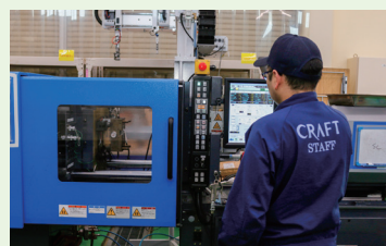
▲金型に樹脂を流し込み、パーツを成型する作業工程
