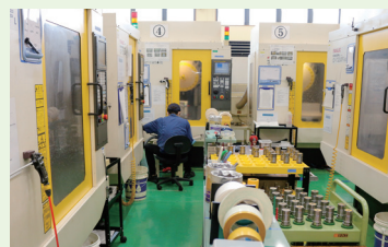
▲会社設立時から得意とする技術の切削加工。一帯彫り加工の工程
